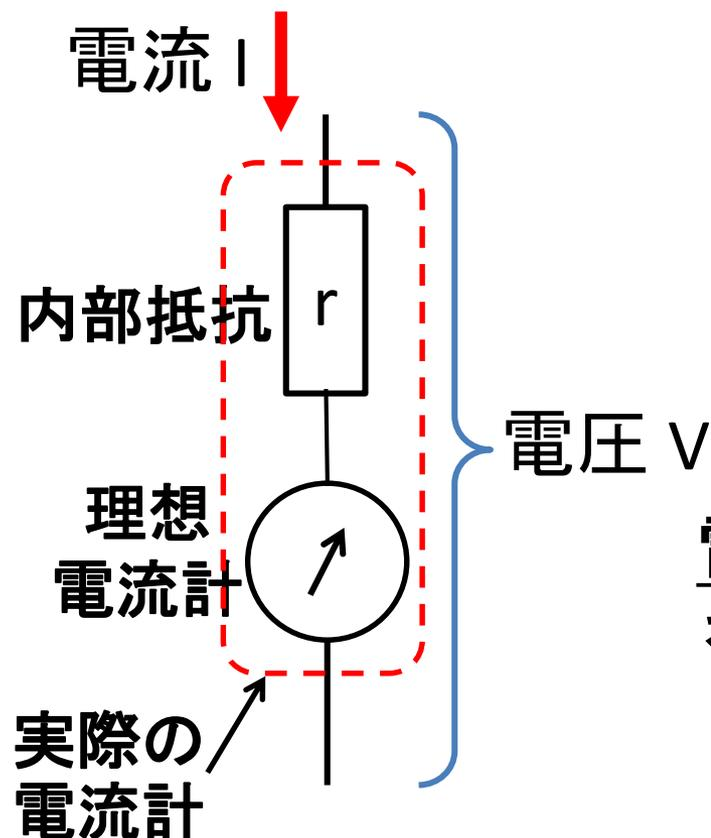
電流計で、電圧を測る
