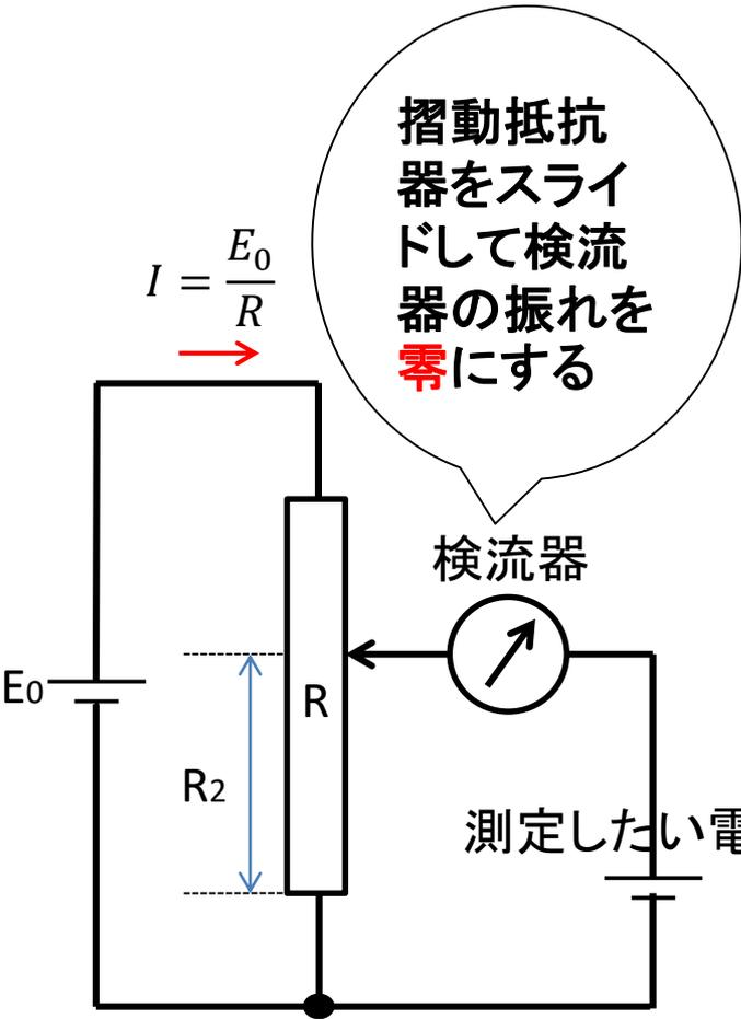
このときも、検流器の回路には電流が流れないので、抵抗 $R$ には電流 $I = \frac{E_0}{R}$ が流れているから、測りたい電圧 $E_x$ は、式(2・16)のようになる
