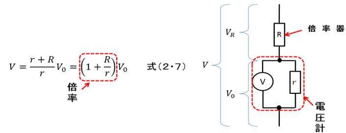
$$\text{式(2.7)} \quad V = \left(1 + \frac{R}{r}\right) V_0 \text{ より}$$
