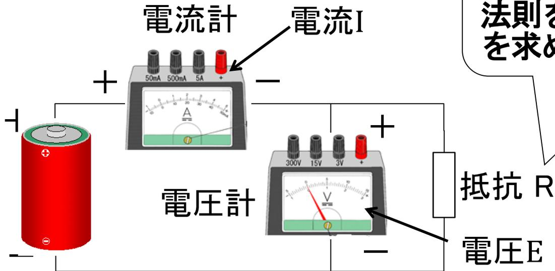
電圧計で電圧 $E$ を、電流計で電流 $I$ を測定して、オームの法則を使って、抵抗値 $R=E/I$ を求める
