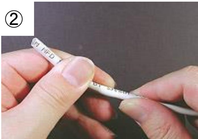
② 被覆の切除をする時に、中の線を傷つけてしまわないように先の切断予定部分のあたりを良く揉む。すると、被覆と中の線が剥がれ、隙間ができる。(ケーブルによっては、被覆に中の線が張り付いてしまっていることがある)
