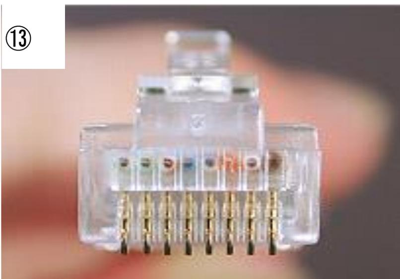
⑬ かしめる前に最終確認します。プラグの先端から見て、中のケーブルの先端がちゃんときているかを確認する。
