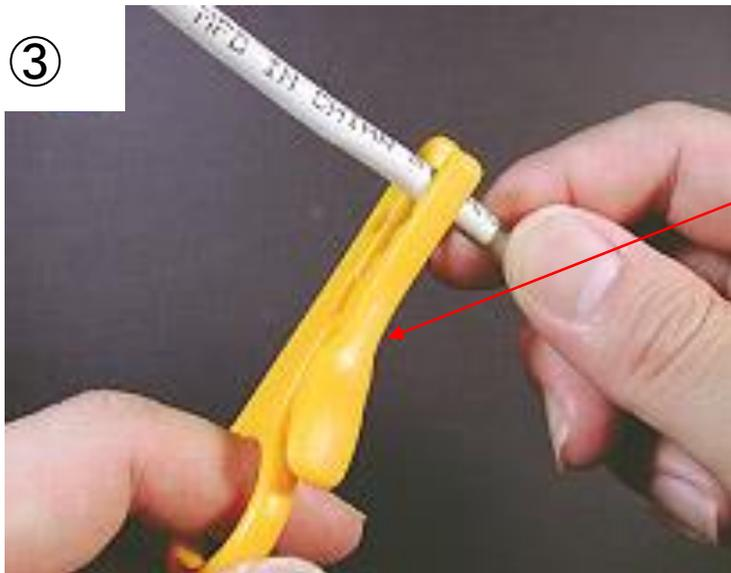
③ 皮むき工具の一番外側の溝にケーブルを挟み込んで、皮むき工具を一回転させる。皮むき工具の穴に指を入れて回す。この時に、刃の部分にケーブルを無理に押し付ける必要なし。工具に挟み込むだけで適度な押さえになる。
